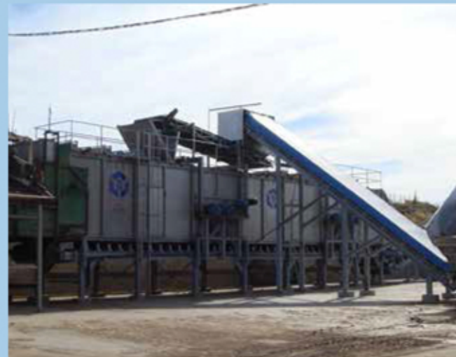
Línea completa mezclado de compost champiñón y setas (Fabricadas en acero inox. y acero galvanizado en caliente. Chasis de gran rigidez)
