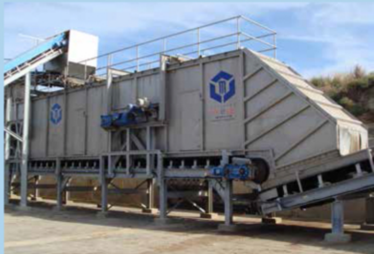
Línea completa mezclado de compost champiñón y setas (Fabricadas en acero inox. y acero galvanizado en caliente. Chasis de gran rigidez)
