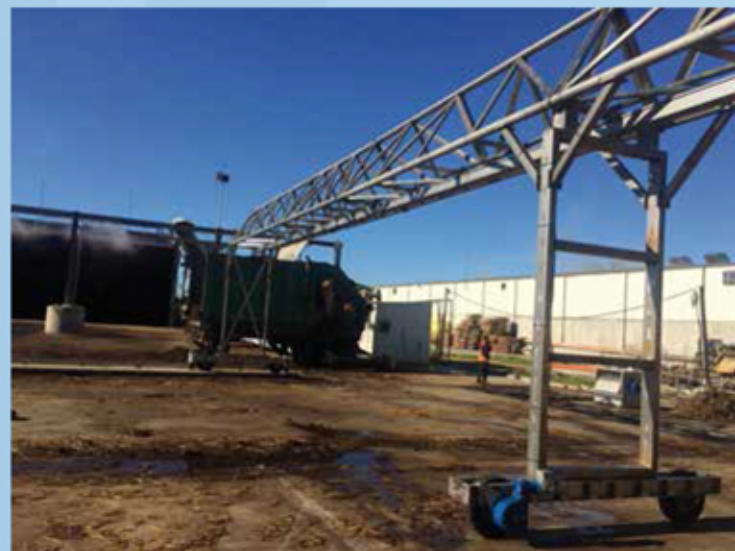
Estructura móvil para premojado de pacas paja (Fabricada íntegramente en acero inox. según necesidades del cliente)
