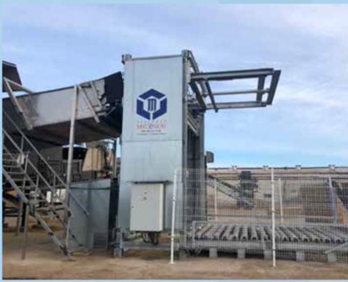
Alimentador automático de pacas paja (Capacidad estándar: 20 pacas y posibilidad de ampliación)
