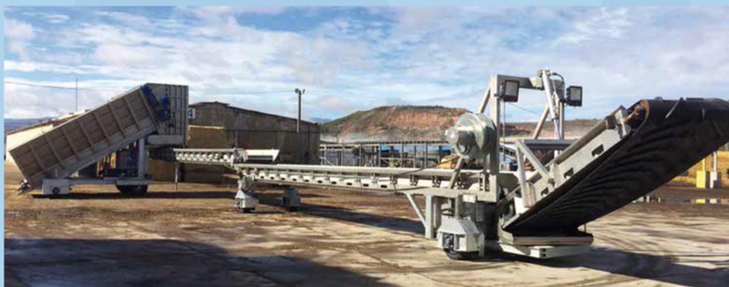
Línea completa llenado de túneles y cámaras compost (Línea de cintas extensibles telescópicas con 4 ruedas motorizadas y giro 90°)
