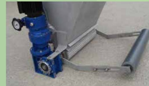
Dosificador de suplemento o cacking (Fabricamos cualquier tipo de dosificador para distintos materiales)
