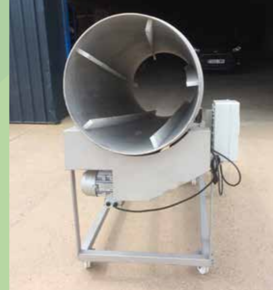
Volteador de bolsas de semillas (Fabricado para el ablandado de bolsas semilla champiñón y setas)
