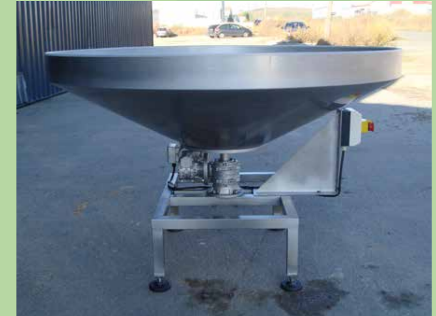
Mesa giratoria (Fabricada en acero inox. para recogida bandejas)
