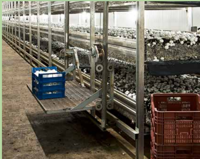
Carro manual de recolección (Distintos tipos de carros manuales, tanto en aluminio como en acero galvanizado)
