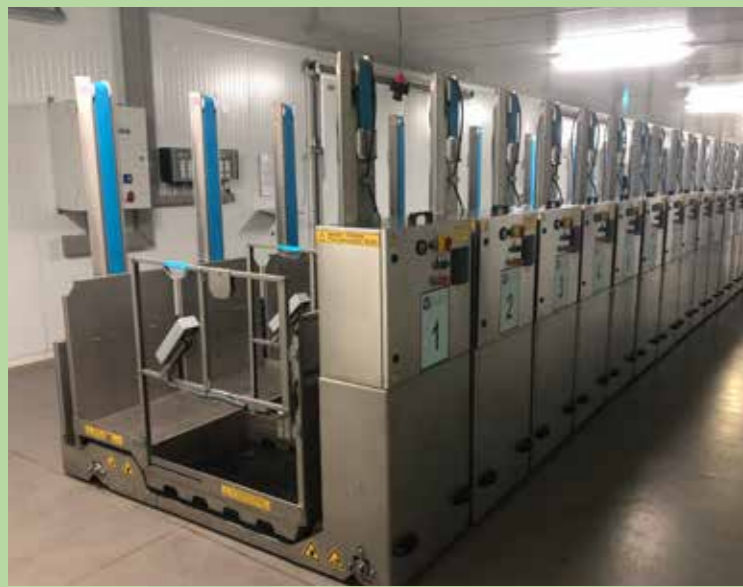
Carro automático inox. elevador para recolección (Fabricados en acero inox. con movimientos de elevación y desplazamiento automáticos)
