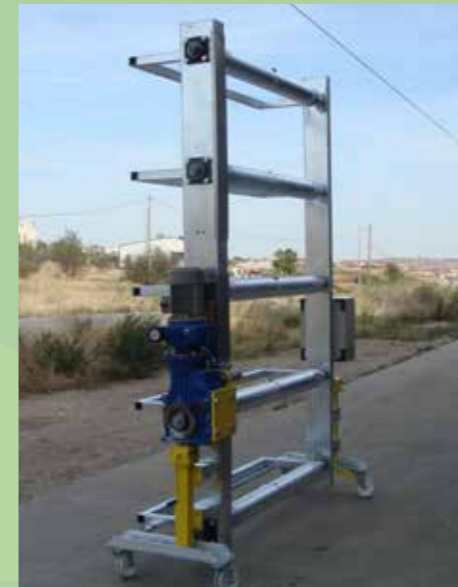
Tiratapetes lonas salas cultivo (Fabricados para 3-5 o más alturas según necesidades del cliente)
