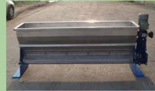
Tiratapetes lonas salas cultivo (Fabricados para 3-5 o más alturas según necesidades del cliente)
