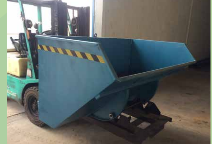
Contenedor de basura (Con volteo manual para descargar)
